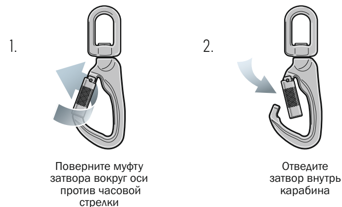
Рис. 3 Принцип работы карабина.
