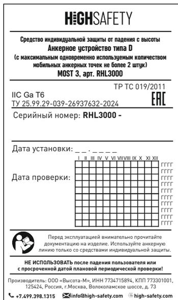
**Рис. 3** Маркировка информационной таблички анкерной линии MOST 3.
