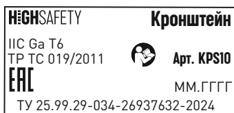
Рис. 26 Маркировка кронштейна KPS10.
