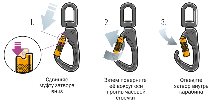
Рис. 3 Принцип работы карабина класса Т.
