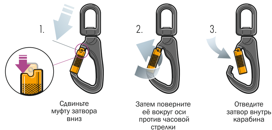
Рис. 3 Принцип работы карабина класса Т.
