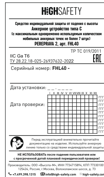
Рис. 3 Маркировка информационной таблички анкерной линии PEREPRAVA 2.
