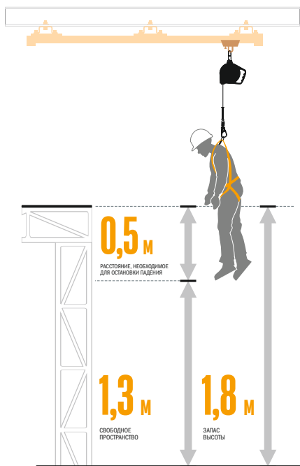
Рис. 7 Минимальная высота (запас высоты) рабочего места при использовании СЗВТ.
