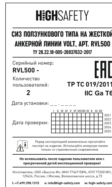
Рис. 3 Маркировка информационной таблички анкерной линии VOLT.
